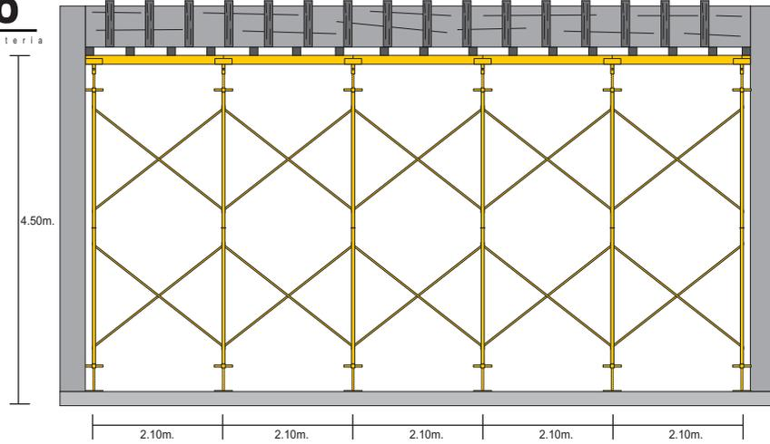
ARRASTRE DE POLÍN O VIGAS MÁXIMO A 70 CM. DE SEPARACIÓN DE VIGA A VIGA
